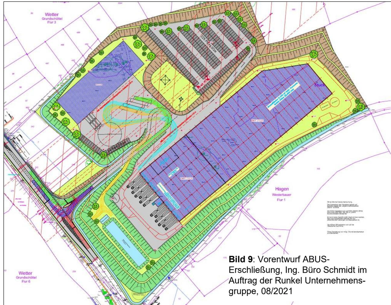
Das Neubauvorhaben sieht in erster Linie eine Logistikhalle auf einer Grundfläche von rund 12.800 m<sup>2</sup> auf dem südlichen Teil des Geländes vor. Die Halle hat eine Länge von 210 m und eine Breite von 65 m. Die Logistikhalle beinhaltet im östlichen Teil ein 9.100 m<sup>2</sup>
