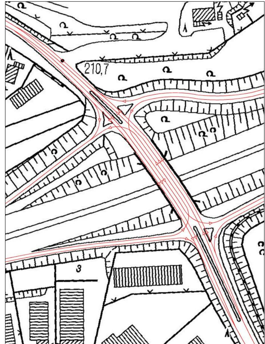
**Bild 23:** Spurenplan bei empfohlener Knotenpunktaufweitung
